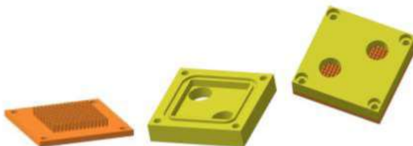
Рис. 2. Модель сборки модуля охлаждения.
